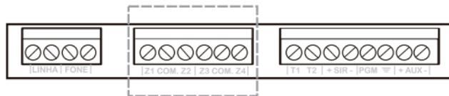
A ligação dos sensores com fio nos bornes das zonas da central de alarme deve ser feita com cabo 4x26 AWG ou superior, com comprimento máximo de 100 m e resistências total de 10  $\Omega$ . Estes bornes estão divididos em grupos de três terminais, sendo o do meio comum e os dos lados entradas para zonas. Por exemplo, para ligar um sensor na zona 1 ligue um dos fios no terminal COM e o outro no terminal Z1.
