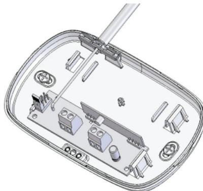
A figura anterior mostra o receptor XAR 2000 (opcional). Quando instalado, a central de alarme aumenta o raio de cobertura para dispositivos RF. Use-o quando houver a necessidade de instalação de sensores sem fio ou controles remoto em longas distâncias cujo alcance na central fique comprometido. A ligação deve ser feita com cabo
