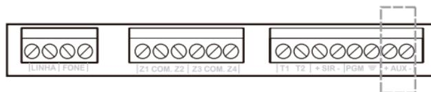
Esta saída é utilizada para alimentar acessórios como, interface para cerca elétrica, sensores de infravermelho, etc.
