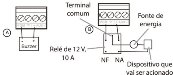
Figura A: ligação de um dispositivo que funcione em 12 V e consuma no máximo 50 mA como por exemplo um buzzer ou um LED (para ligar um LED é necessário colocar um resistor de 1 k $\Omega$  em série para limitar a corrente).
